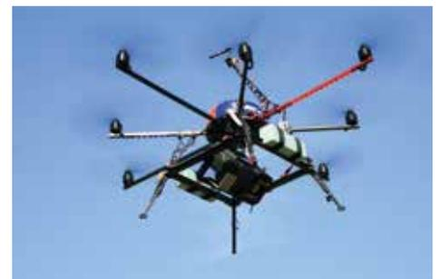
Die Drohne besteht aus einem Oktokopter, der FLIR T620 und einer vertikal schwenkbaren Kamera-Aufhängung – mit einem Gesamtgewicht von deutlich unter 5 kg.
