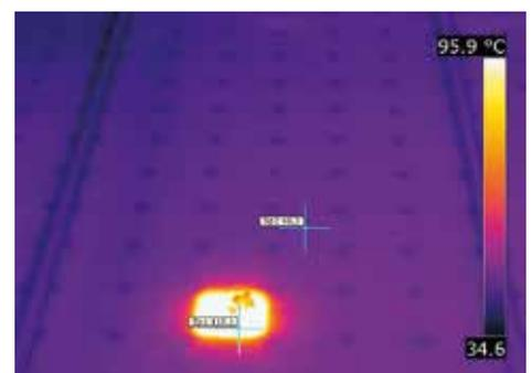
Thermografie aus der Luft: Hotspot auf einem Photovoltaik-Modul.
