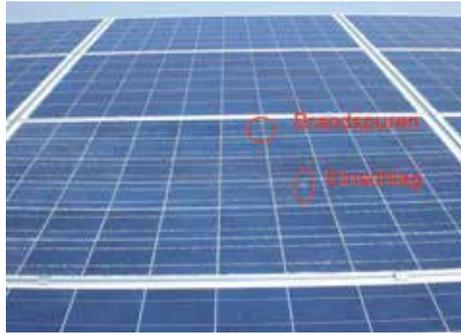
Brandspuren und Einschläge auf einem PV-Modul sind nicht immer so deutlich bereits mit bloßem Auge erkennbar.
