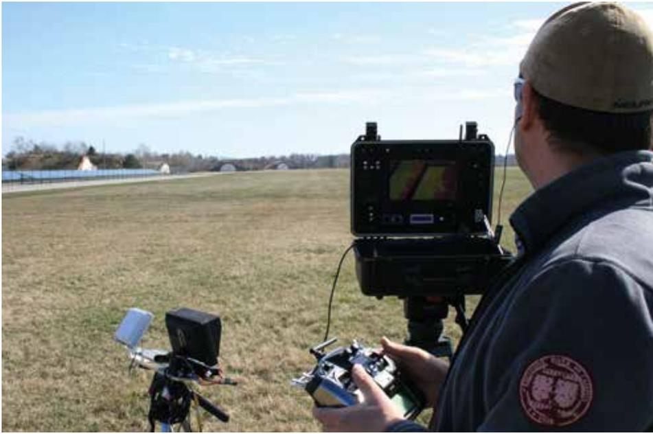
Mario Hamsch mit der Fernsteuerung der Drohne und dem Messkoffer, auf dessen Monitor der Livestream angezeigt wird. Der Infrarot-Live-Stream wird permanent an die Bodenstation übertragen, von einem digitalen Rekorder aufgenommen und auf dem Monitor eines speziell konstruierten Messkoffers angezeigt. Links auf dem Stativ zu sehen: Die Antenne für die Verbindung zu Drohne und Wärmebildkamera.
